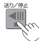
送り / 停止 ボタンを押すとシート面を 1 面分左にスクロールして自動停止します。
