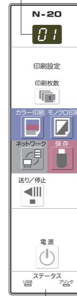
コピーBOARDの電源が入っている(表示窓が01表示している)ことを確認してください。
