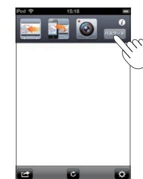
6. パスワード確認ボタンをタップし、コピーBOARDの表示窓に点滅表示されている2桁の数字を入力し、完了ボタンをタップします。
