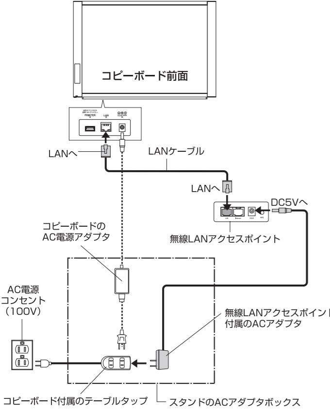
2. 無線LANアクセスポイントに付属のACアダプタのDCプラグを無線LANアクセスポイントのDC5V端子へ接続します。
