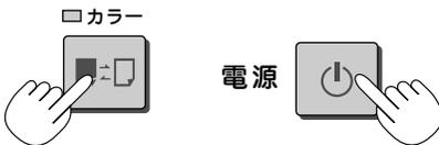
「等比圧縮モード」に切り替わり、モードが切り替わるとカラーモード表示ランプが 5 秒間点滅します。
